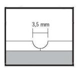
Con la fresa (elettrica o manuale) effettuare una scanalatura lungo le giunzioni tra le piastrelle o i teli. La scanalatura sarà profonda i 2/3 dello spessore del pavimento (fino ad un massimo di 2 mm) e larga circa 3,5 mm. Pulire accuratamente, eliminando polvere e residui di fresatura. Nei pavimenti con sottofondo elastico, DOTFLOOR N/SEL, la scanalatura non dovrà intaccare lo strato di sottofondo.
