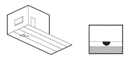
Dopo aver lasciato raffreddare il cordolo, rifilare la parte rimasta in rilievo utilizzando il coltello senza la slitta e facendo attenzione a non intaccare la superficie del pavimento.
