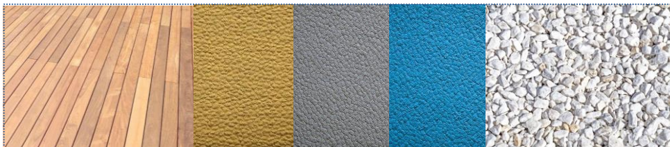
Abaco riassuntivo dei materiali degli spazi esterni: (1) Decking in Ipe Lapacho, (2) Pavimentazione in gomma, (3) Ghiaia di cava
